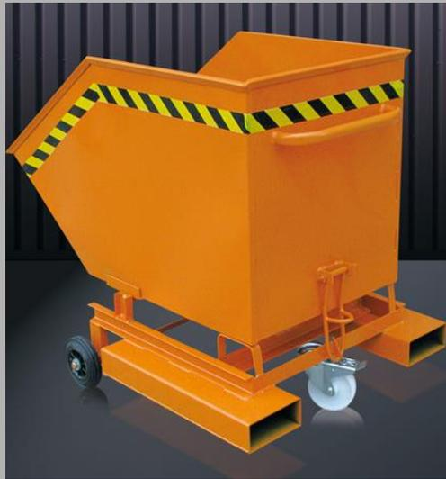
„Handwagen“ mit Komfort. Ob schnell von Hand bewegt und gekippt – oder doch rückschonend mit dem Stapler transportiert: Der Kastenwagen erleichtert viele Wege und Abläufe. Mit zwei Bockrollen und einer Lenkrolle extrem wendig. Öl- und wasserdicht verschweißt, mit umlaufender Kantenverstärkung, massivem Stahlprofil-Rahmen und Abrutschsicherung.
